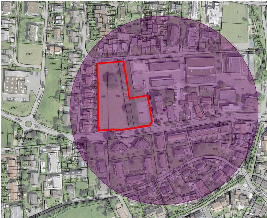
Abbildung 19 Mobilfunkanlage mit Strahlungsperimeter (Quelle: Geodaten Kanton Basel-Landschaft / eigene Darstellung)
